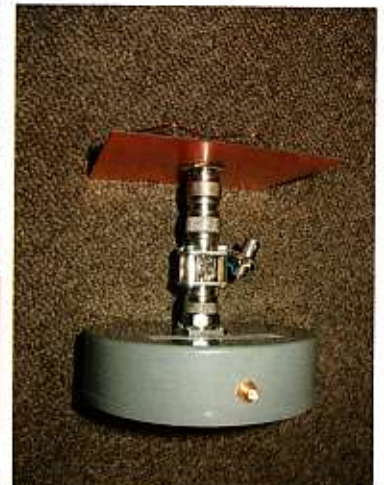
De biquad van de zijkant gezien.
